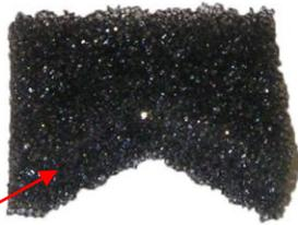
Schaumstoff als Schalldichtung zuschneiden (Verhindert akustischen Kurzschluss)
